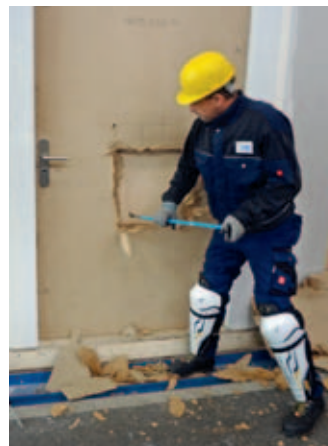
Versuch, innerhalb von 5 min. eine durchstiegsfähige Öffnung zu schaffen
